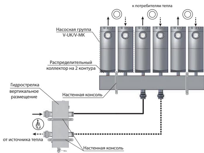
**Вариант №2:** Гидрострелка располагается вертикально и монтируется отдельно от распределительного коллектора.
