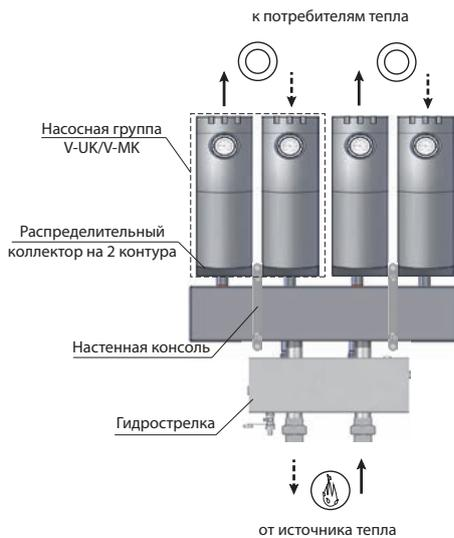
**Вариант №1:** Гидрострелка располагается горизонтально и монтируется непосредственно на патрубки распределительного коллектора.
