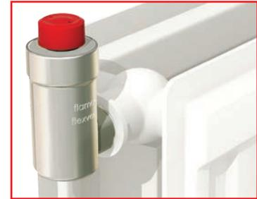
Модель Flexvent H имеет соединение  $\frac{1}{2}$ ", расположенное под прямым углом к корпусу, что означает возможность непосредственного подключения к одному из отверстий радиатора.
