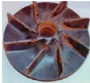
Повреждение крыльчатки насоса
