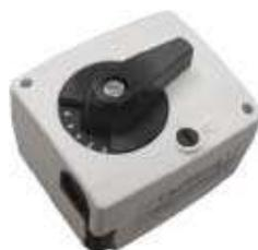
Предназначен для управления 3-х ходовым смесителем насосно-смесительного модуля МК от автоматики котельной. Сервопривод монтируется непосредственно на смеситель.
