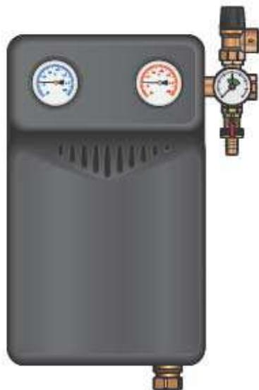
Солнечная станция М 3/4" с посадочным местом под насос Ду 25 мм (НГ 1 1/2", база 180 мм), двухтрубное исполнение. Предназначена для обеспечения циркуляции теплоносителя в геоконтуре площадью до 12 м<sup>2</sup>.
