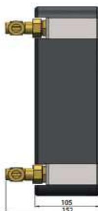
Габаритные и монтажные размеры теплообменника IC8Tx24 (30кВт)
