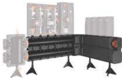
Распределительный модуль состоит из теплоизолированных подающего и обратного коллекторов, расположенных друг над другом в виде единого модуля. Верхний коллектор - подающий, нижний - обратный. Подключение котельного контура к распределителю возможно как слева, так и справа. Подающая линия контуров потребителей расположена слева в силу заводского исполнения модуля.
