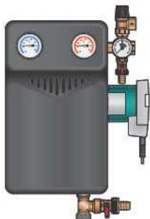
Солнечная станция L1" с посадочным местом под насос Ду 25 мм (НГ 1 1/2", база 180 мм), двухтрубное исполнение. Предназначена для обеспечения циркуляции теплоносителя в геоконтуре площадью до 50 м<sup>2</sup>.
