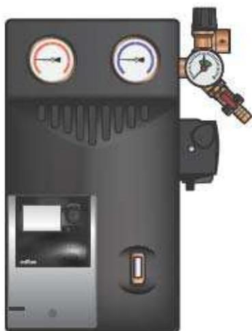
Солнечная станция S 3/4" с посадочным местом под насос Ду 15 мм (НГ 1", база 130 мм) со встроенным контроллером Huch SR1, двухтрубное исполнение. Предназначена для обеспечения циркуляции теплоносителя в гелиоконтуре площадью до 12 м<sup>2</sup>.
