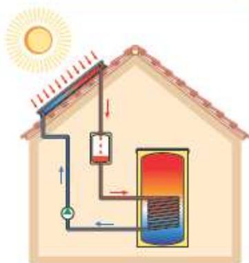
Когда автоматика гелиосистемы получает запрос на производство тепла, она включает циркуляционный насос солнечной станции, который заполняет коллекторы теплоносителем, и начинается перенос тепла из солнечных коллекторов в ёмкостный водонагреватель.
