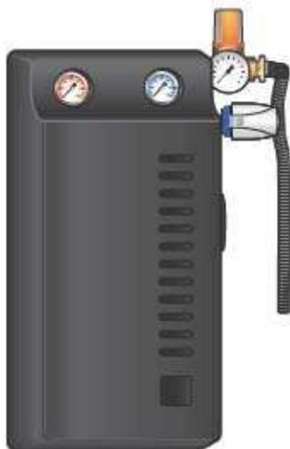
Солнечная станция SolaVentec II 3/4" с посадочным местом под насос Ду 25 мм (НГ 1 1/2", база 180 мм), двухтрубное исполнение, без обратных клапанов. Имеет сниженное гидравлическое сопротивление, что позволяет получить на выходе повышенную остаточную производительность насоса. Предназначена для обеспечения циркуляции теплоносителя в гелиоконтуре площадью до 26 / 50 м<sup>2</sup>.
