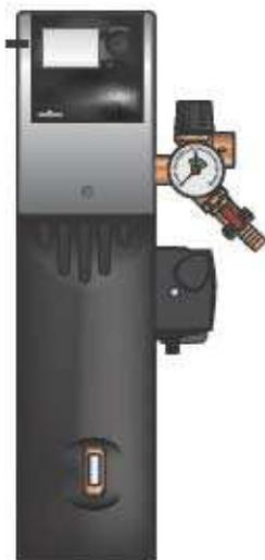
Солнечная станция S 3/4" с посадочным местом под насос Ду 15 мм (НГ 1", база 130 мм) и со встроенным контроллером Huch SR1, однотрубное исполнение. Предназначена для обеспечения циркуляции теплоносителя в гелиоконтуре площадью до 12 м<sup>2</sup>.
