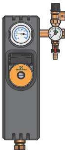
Солнечная станция М 3/4" с посадочным местом под насос Ду 25 мм (НГ 1 1/2", база 180 мм), однотрубное исполнение. Предназначена для обеспечения циркуляции теплоносителя в гелиоконтуре площадью до 12 м<sup>2</sup>.
