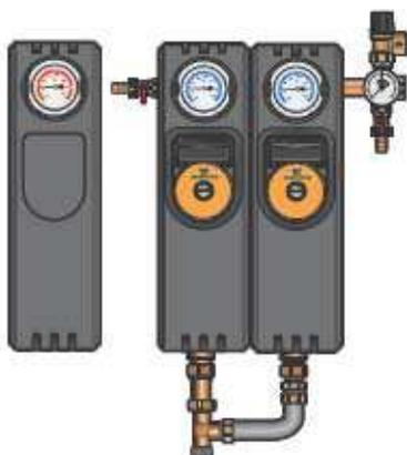
Солнечная станция Ost-West 3/4" с двумя обратными линиями и одной подающей линией для обеспечения циркуляции теплоносителя в двух гелиополях площадью до 12 м<sup>2</sup>, каждое из которых направлено в разные стороны света (Восток-Запад). Позволяет дискретно снимать тепло с того гелиополя, на которое светит Солнце.
