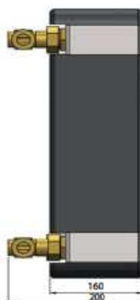
Габаритные и монтажные размеры теплообменника IC8Tx30 (40кВт)
