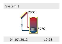
После устранения неисправности, появляется главный экран оборудования без значка Внимание на дисплее, прибор продолжает работу в автоматическом режиме.
