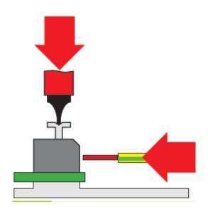
Для подключения, нажмите на кнопку включения пружинной колодки, используя отвертку, и вставьте провод до упора в соответствующий порт.
