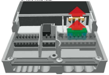
Чтобы извлечь предохранитель прибора, откройте крышку клеммной коробки. Над группой колодок справа находятся держатель предохранителя и запасной предохранитель. Потяните верхнюю часть подставки и вытащите запасной предохранитель. Плавкая вставка предохранителя закреплена в фасонной детали и извлекается вместе с пластиковым держателем.
