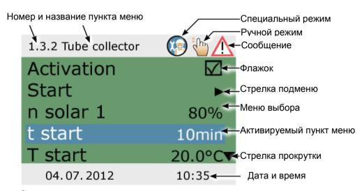
Элементы дисплея; пример: экран передачи информации
