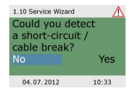
Если причина неисправности не была установлена, процесс устранения неполадок может быть продолжен. Нажмите «Нет».
