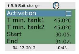
Функция легкой загрузки переводит оборудование в режим защиты в целях предотвращения чрезмерно высокой температуры резервуара.
