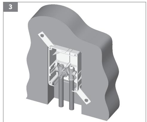
Beim Anschluss an das Rohrleitungsnetz ist auf spannungsfreien Anschluss und auf die korrekte Fließrichtung (Vorlauf links - siehe Pfeilmarkierung!) zu achten. Vertauschte Anschlüsse führen zu Ventilgeräuschen und schlechtem Regelverhalten.
