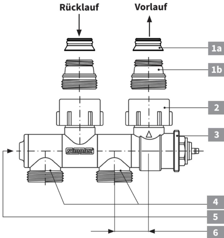
**1a** Konus für den Anschluss an HK mit 3/4" Außengewinde (Eurokonus) - in Heizkörperanschluss eindrücken, bzw.
