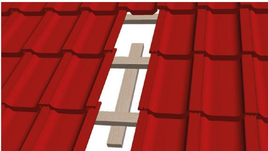
Befestigen der untenliegenden Latte  $24 \times 80 \times 600 \text{ mm}$  mit zwei Schrauben  $4 \times 50 \text{ mm}$ .
