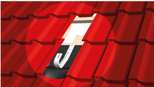
Der Ziegelhaken darf den unteren Ziegel nicht überdecken. Andernfalls kann ein Druckpunkt auf dem unteren Ziegel entstehen.
