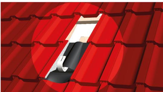
Der beigelegte Schaumstoffkeil wird auf beiden Seiten sowie oben unter die angrenzenden Ziegel verlegt (Spritzwasser und Flugschneesicherung).
