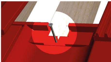
Neben dem Schroten des Dachziegels wird empfohlen, eine in die Ziegelhakenauflage eingebrachte Schraube als Abstandssicherung zu nutzen.
