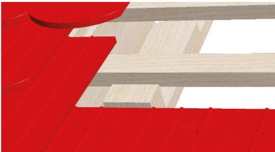
Montage der unteren Ziegelhakenauflage 80 x 50 x 45 mm mit zwei Schrauben 5 x 60 mm.
