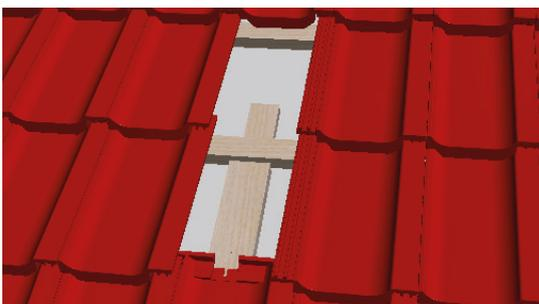
Montieren Sie nun die Ziegelhakenaufgabe  $80 \times 270 \times 30 \text{ mm}$  und befestigen Sie diese mit zwei Schrauben  $5 \times 60 \text{ mm}$ .
