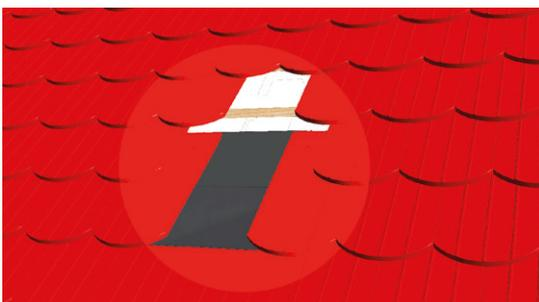
Montage des unteren Bleilappens. Das Blei wird dabei seitlich unter die Ziegel verlegt.
