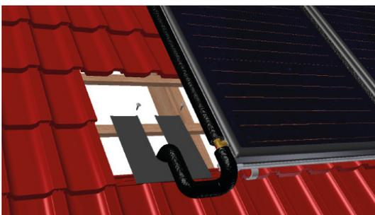
Das Unterteil wird an die Anschlussleitung angesetzt und mit Schrauben fixiert.
