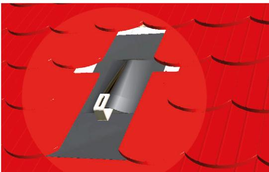
Montage des oberen Bleilappens. Das Blei wird seitlich unter die Ziegel verlegt.
