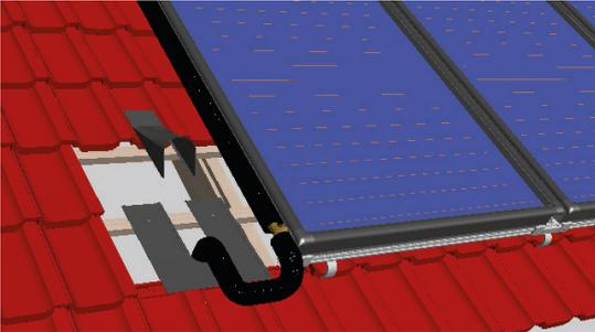
Im nächsten Schritt wird die Blechhaube von oben aufgeschoben.
