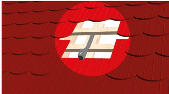
Befestigen der untenliegenden Latte 24 x 80 x 600 mm mit zwei Schrauben 4 x 50 mm.
