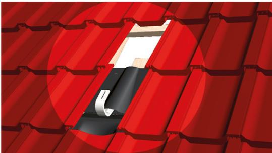
Den oberen Montagelappen montieren. Seitlich ebenfalls aufbiegen.
