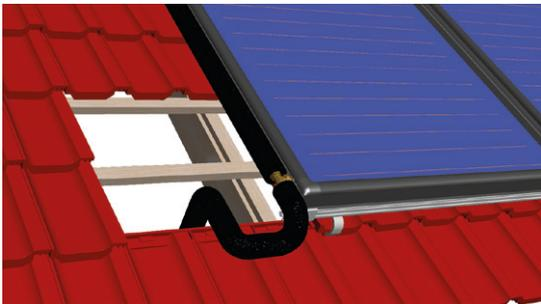
Die Anschlussleitung wird durch das Dach geführt und anschließend mit dem Kollektoranschluss verbunden.
