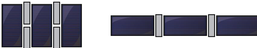
Bei den Kollektortypen FKF 200 V, FKF 240 V und FKF 270 V werden zwischen jedem Kollektorübergang zwei Zwischenbleche montiert. Für die Kollektoren FKF 200 H, FKF 240 H und 270 H ist die Montage eines Zwischenbleches vorgesehen. Bei der Montage mehrreihiger Anlagen, werden die Zwischenbleche wie anbei beschrieben, montiert. Die Zwischenbleche können von oben oder unten montiert werden.
