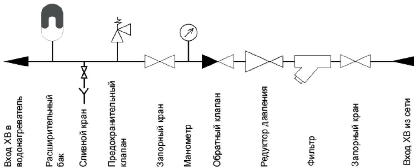
5.3 При подключении к системе водоснабжения должна быть предусмотрена возможность слива воды из водонагревателя.
