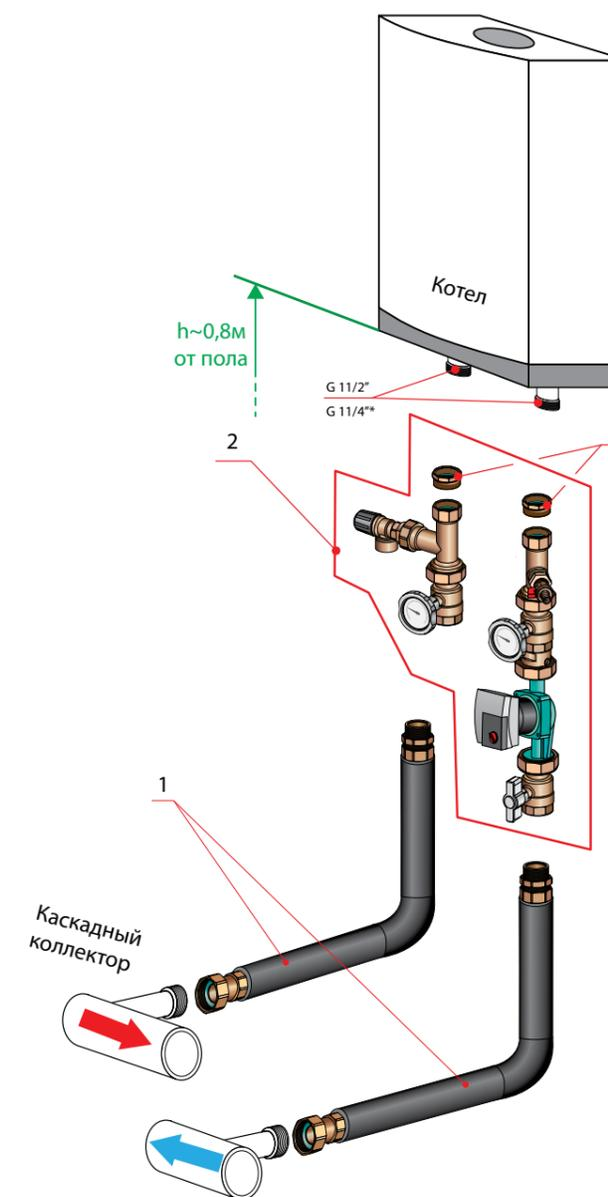
Обычно, настенные конденсационные котлы мощностью 80 -100 кВт нуждаются в подключении внешнего циркуляционного насоса и предохранительного клапана. Для решения этой задачи, Майбес предлагает следующий пример решения:
